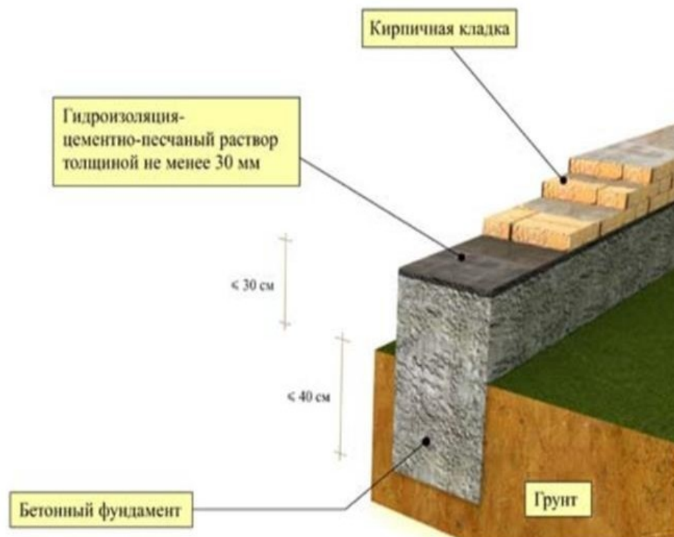
Рисунок 7. Ленточный бетонный фундамент
